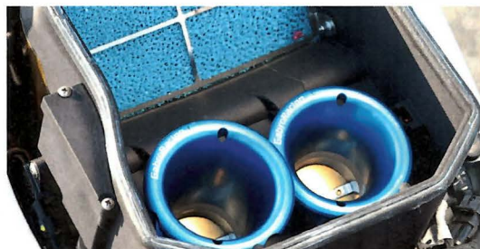
Unterschiedlich lange Ansaugtrichter für füllige Leistung in allen Drehzahlregionen
