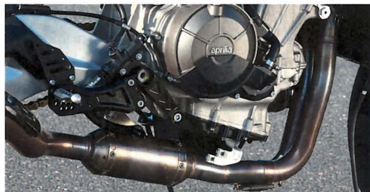
Die Akrapovic-Anlage besitzt einen Mittelschalldämpfer und einen gekürzten Endtopf
