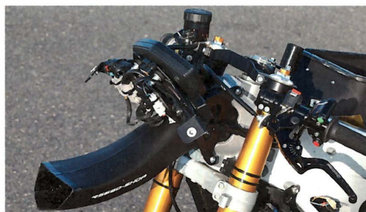
Der zentrale Ram-Air-Kanal wurde von WSC eigens für die RS 660 entwickelt
